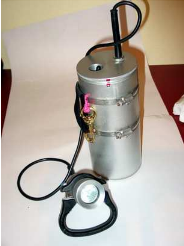
Foco HID Tritón terminado ( incluye algunos accesorios no suministrados)
