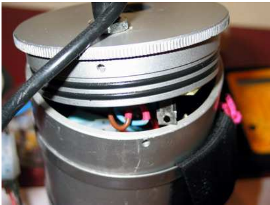
Doble junta tórica en la tapa
