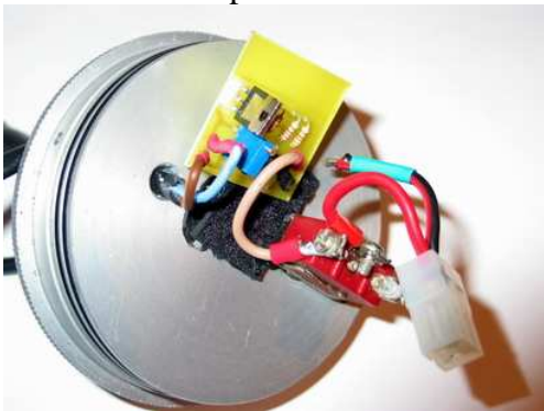
circuito protector y parte trasera del interruptor
